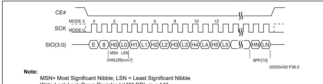
**FIGURE 5-49: WRITE-LOCK LOCK-DOWN REGISTER SEQUENCE (SPI)**
