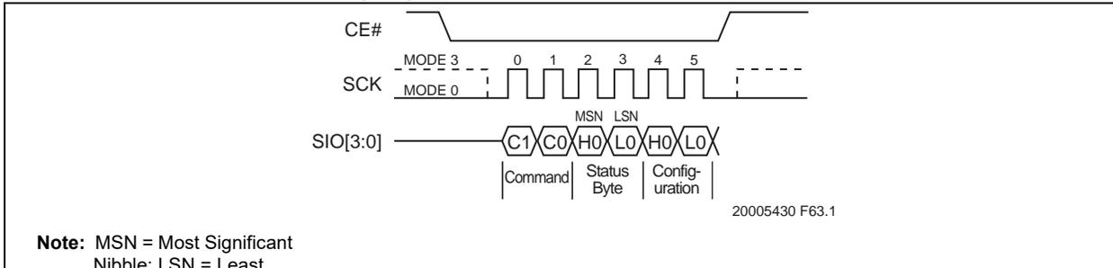
**FIGURE 5-37: WRITE-STATUS-REGISTER AND WRITE CONFIGURATION REGISTER SEQUENCE (SPI)**
