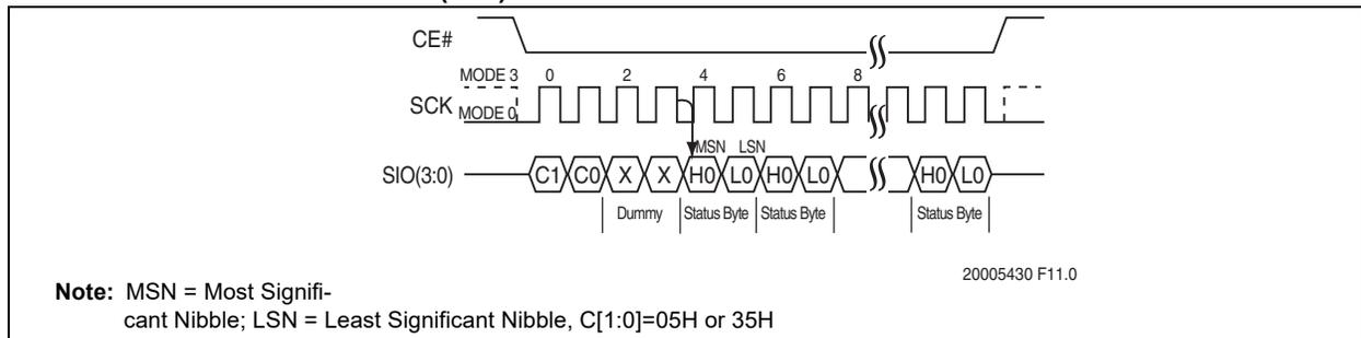
**FIGURE 5-35: READ-STATUS-REGISTER AND READ CONFIGURATION REGISTER SEQUENCE (SPI)**
