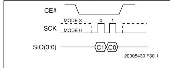
**FIGURE 5-47: LOCK-DOWN BLOCK-PROTECTION REGISTER (SPI)**
