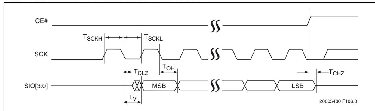
FIGURE 8-6: AC INPUT/OUTPUT REFERENCE WAVEFORMS
