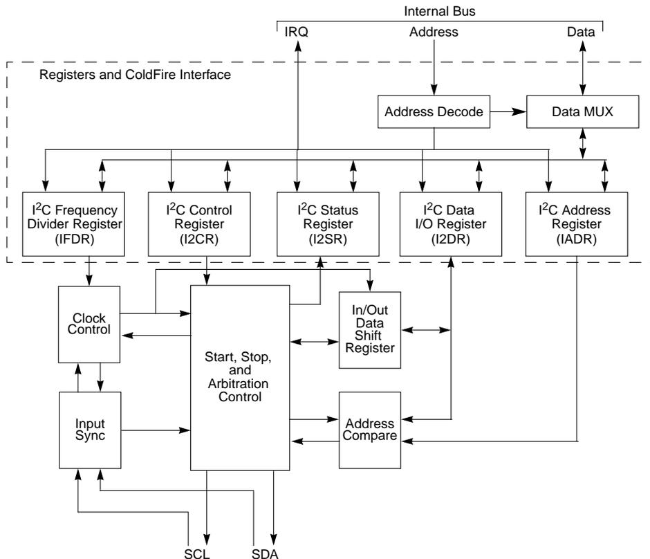
**Figure 8-1. I<sup>2</sup>C Module Block Diagram**
