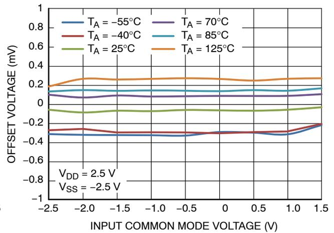
Figure 11.  $V_{OS}$  vs.  $V_{CM}$  ( $V_S = 5\text{ V}$ )
