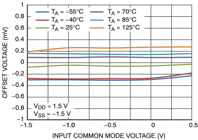
Figure 10.  $V_{OS}$  vs.  $V_{CM}$  ( $V_S = 3\text{ V}$ )
