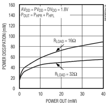
**POWER DISSIPATION vs. POWER OUT**
