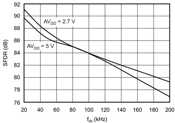
**Figure 24. SPURIOUS-FREE DYNAMIC RANGE vs INPUT SIGNAL FREQUENCY**
