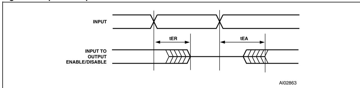
Figure 30. Asynchronous Reset / Preset
