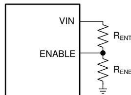
**Figure 12.  $V_{IN}$  UVLO**
