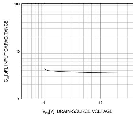
Figure 6.  $C_{iss}$ - $V_{DS}$
