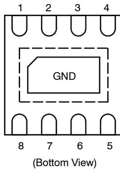
**Figure 3. Pin Diagram**
