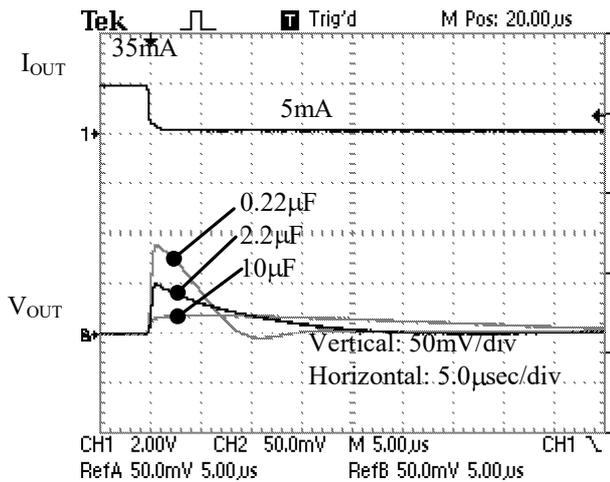
■ Parameter:  $C_L = 0.22\mu F, 2.2\mu F, 10\mu F$
