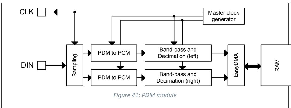
Figure 41: PDM module
