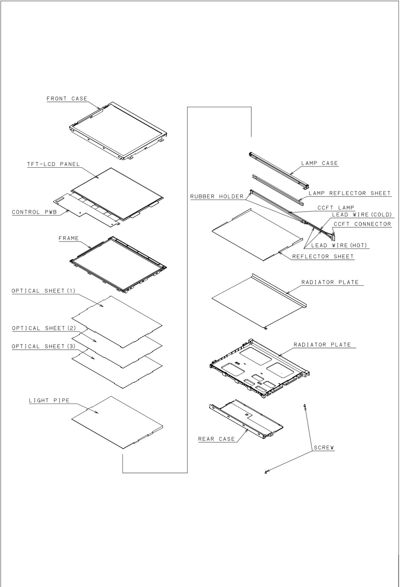
FIG.2 MODULE CONFIGURATION
