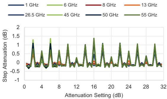
**Figure 27** ■ 1 dB Step Attenuation vs. Frequency<sup>(2)</sup>
