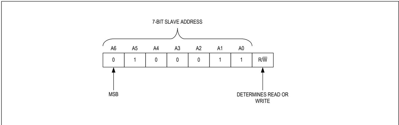
Figure 9. DS2477 I<sup>2</sup>C Slave Address
