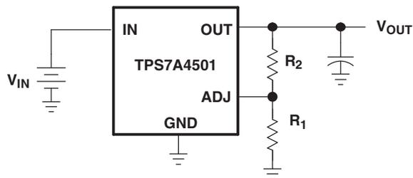
$$V_{\text{OUT}} = 1.21 \text{ V} \left( 1 + \frac{R2}{R1} \right) + (I_{\text{ADJ}})(R2)$$
