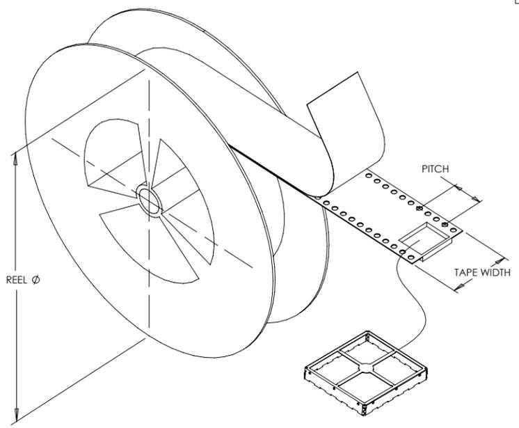
PART MARKING ON SIDES IS NOT INTENDED TO BE RELEVANT TO PART ORIENTATION IN CARRIER TAPE.
