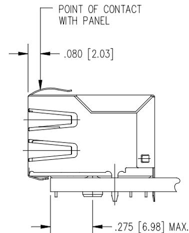
1. THE SUGGESTED PANEL OPENING IS INTENDED TO GIVE THE USER THE ABILITY TO HAVE REASONABLE JACK / PANEL CLEARANCES YET MAINTAIN RELIABLE GROUNDING CAPABILITY.
