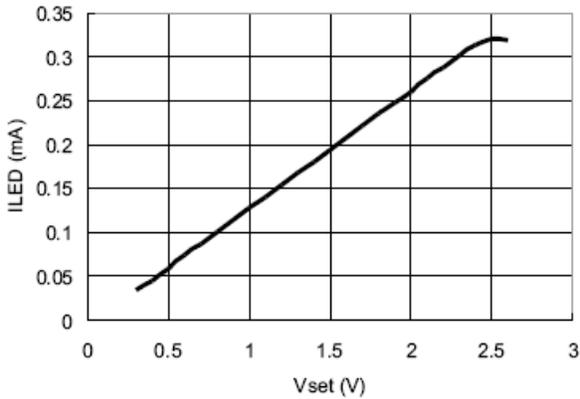
12. I<sub>LED</sub> VS V<sub>SET</sub> (V<sub>IN</sub>=16V, 3 LEDs, 47µH, R<sub>S</sub>=0.15Ω)
