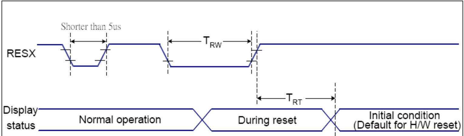
$V_{DD1}=1.65$  to  $3.3V$ ,  $V_{DD}=2.4$  to  $3.3V$ ,  $AGND=DGND=0V$ ,  $T_a=-30 \sim 70 \text{ } ^\circ C$
