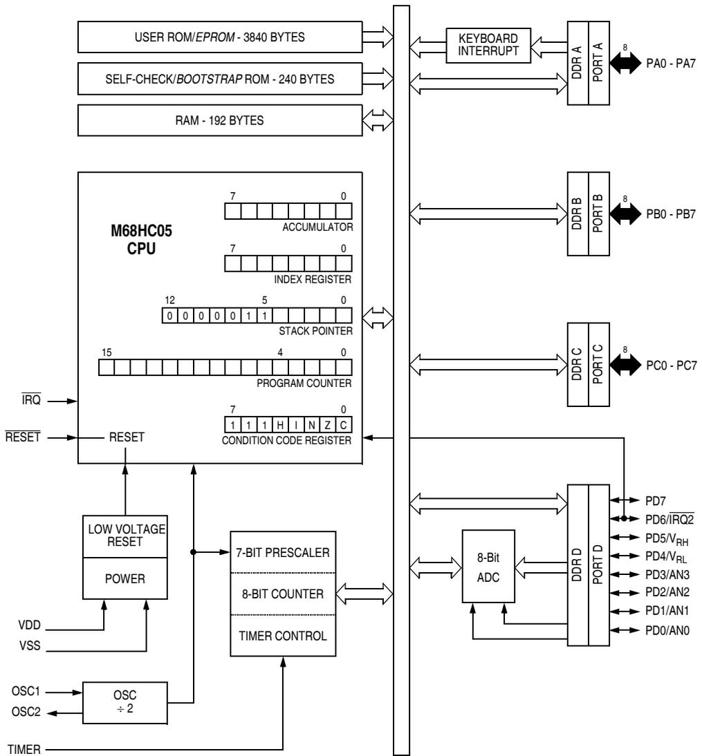
Figure 1-1 MC68HC05SR3/MC68HC705SR3 Block Diagram
