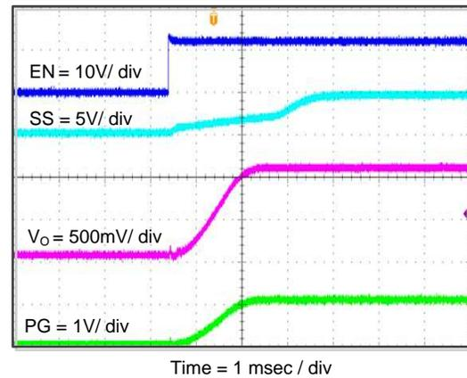
Figure 27. TPS562219A Start Up Relative To EN
