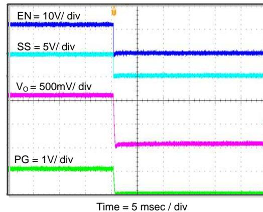
Figure 29. TPS562219A Shut Down Relative To EN
