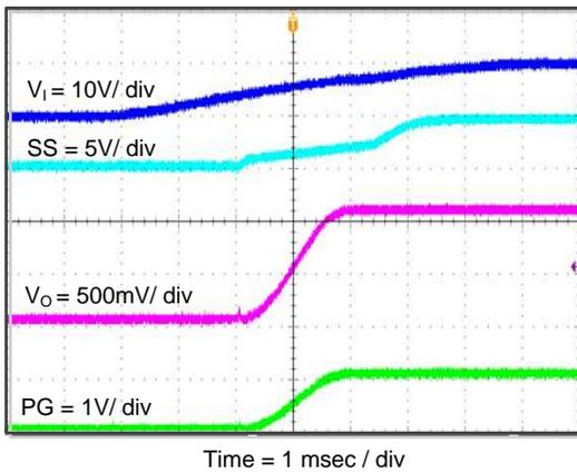
Figure 26. TPS562219A Start Up Relative To  $V_I$
