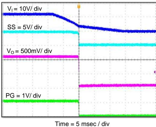
Figure 28. TPS562219A Shut Down Relative To  $V_I$
