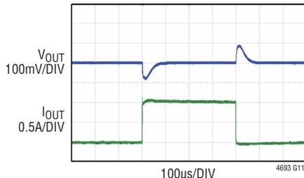
V<sub>IN</sub> = 3.3V, V<sub>OUT</sub> = 1.8V, f<sub>SW</sub> = 1MHz
