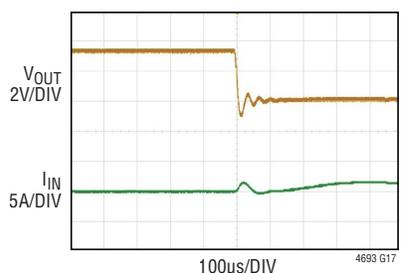
V<sub>IN</sub> = 3.3V, V<sub>OUT</sub> = 3.3V, f<sub>SW</sub> = 1MHz, 0A LOAD
