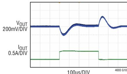
V<sub>IN</sub> = 2.6V, V<sub>OUT</sub> = 5V, f<sub>SW</sub> = 1MHz
