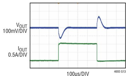
V<sub>IN</sub> = 5V, V<sub>OUT</sub> = 3.3V, f<sub>SW</sub> = 1MHz
