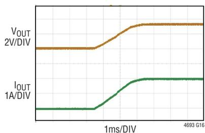
V<sub>IN</sub> = 3.3V, V<sub>OUT</sub> = 3.3V, f<sub>SW</sub> = 1MHz, 2A LOAD
