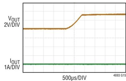
V<sub>IN</sub> = 3.3V, V<sub>OUT</sub> = 3.3V, f<sub>SW</sub> = 1MHz, 0A LOAD
