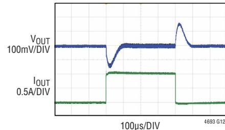
V<sub>IN</sub> = 3.3V, V<sub>OUT</sub> = 3.3V, f<sub>SW</sub> = 1MHz
