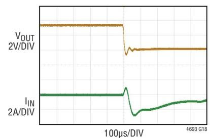
V<sub>IN</sub> = 3.3V, V<sub>OUT</sub> = 3.3V, f<sub>SW</sub> = 1MHz, 2A LOAD
